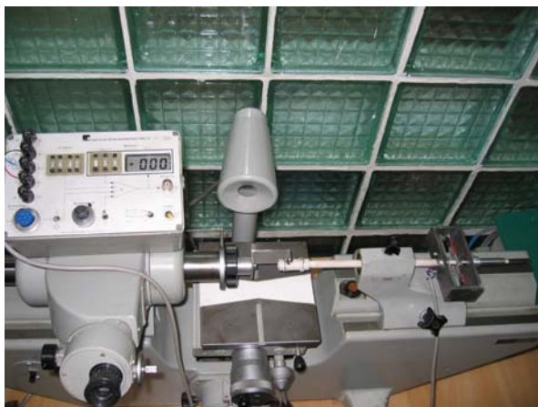
Фигура 8. Снимка на екстензометъра, монтиран в стенда за еталониране.
