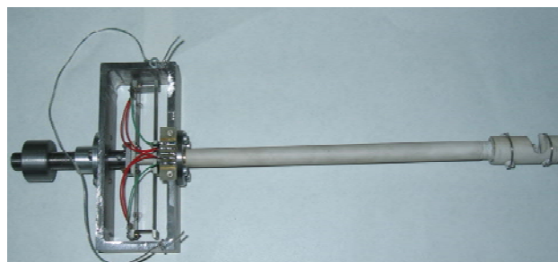
Фигура 6. Снимка на изработения екстензометър.
