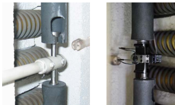
Фигура 9. Снимки на екстензометрите, монтирани на пробно тяло.
