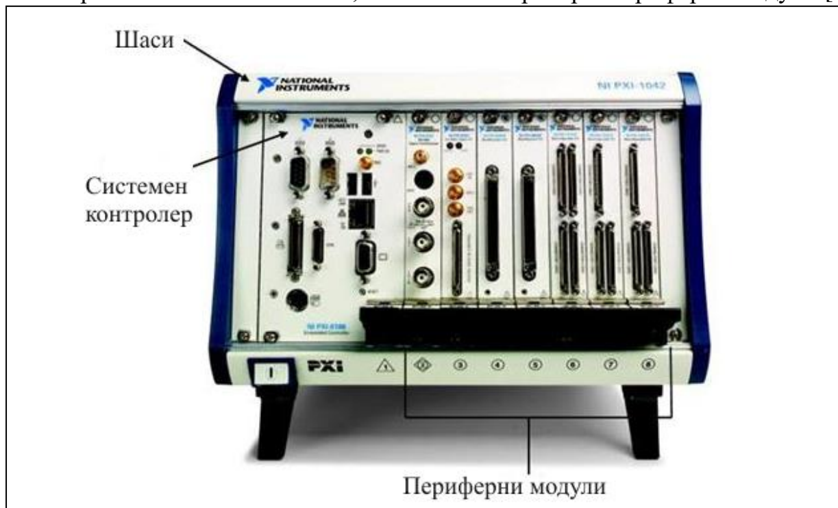
Фиг.1. Общ вид на 8-слотово PXI шаси с вграден системен контролер и периферни модули.
