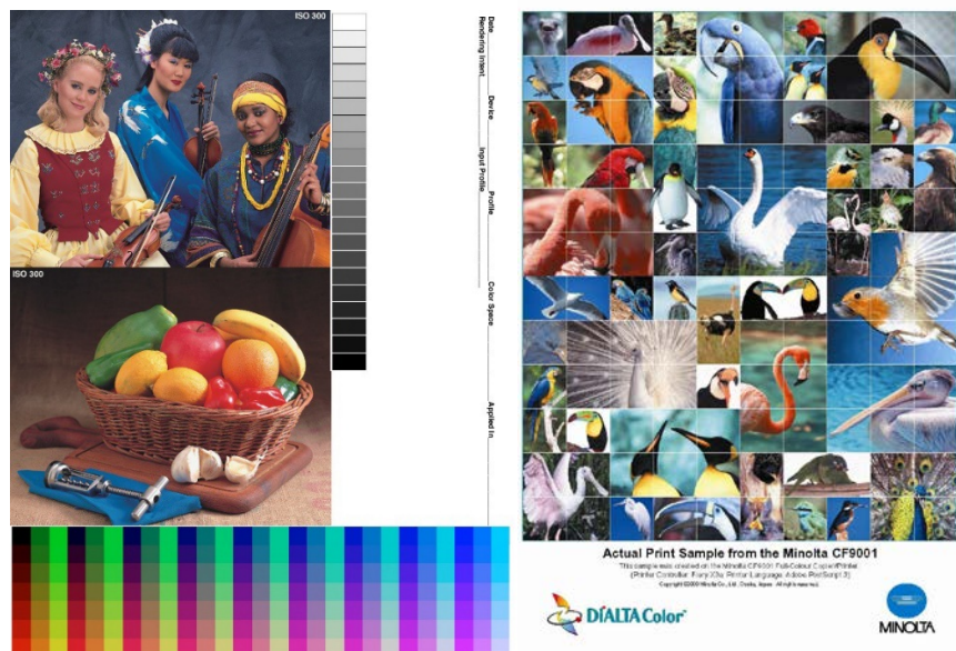
Фиг.1 – Тестова страница I (ляво), дефинирана в LAB пространство, представляваща трудна цел за печат, защото съдържа много наситени цветове извън гамата на много лазерни принтери. Тестова страница II (дясно), дефинирана в CMYK цветово пространство, с прикачен стандартен офсетов профил за печат coated Fogra39
