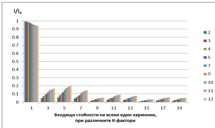
Фиг.7. Входящия хармоничен състав на първичния ток при различен к-фактор
