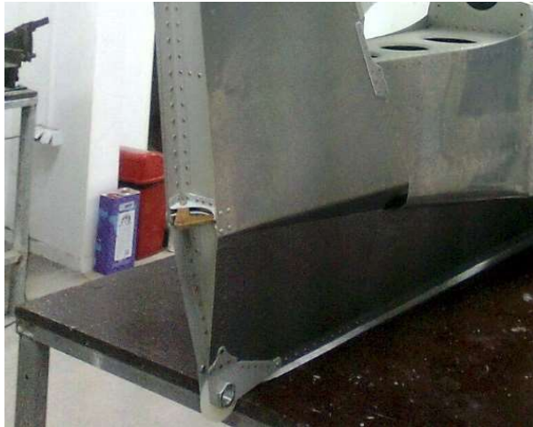
Фиг.1 Примерна конзола - долния шарнир на вертикалното кормило на самолет М-540.
