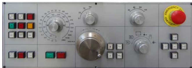
Фиг. 2. Разработен пулт за управление за стругова машина.
