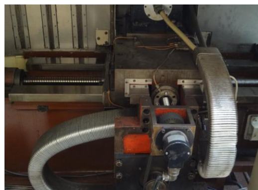
Фиг. 4. Двукоординатно електрозадвиждане x-z.
