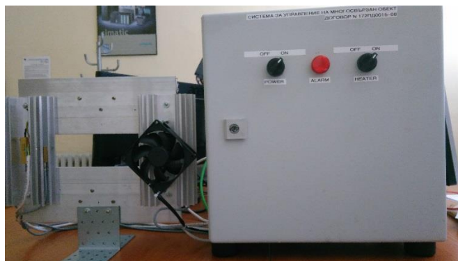
Фиг.2. Снимка на системата - табло за управление и термичен обект
