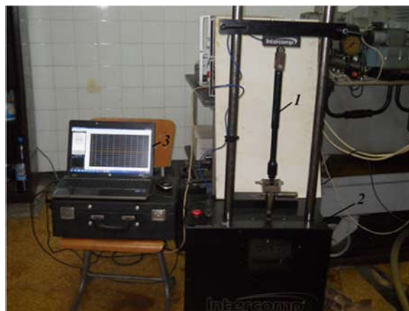
Фиг. 4. Апаратура за изпитване на хидравлични кормилни демпфери: 1. Кормилен демпфер; 2. Стенд за изпитване на демпфери; 3. Преносим компютър.
