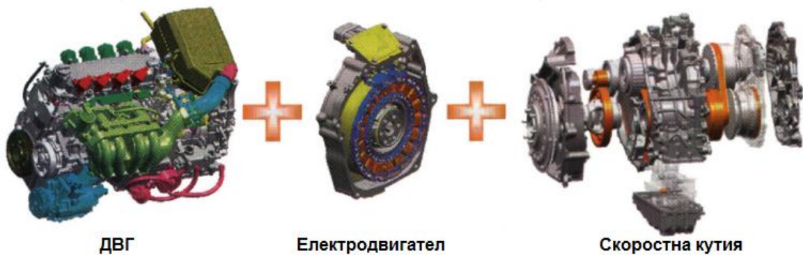
Фиг. 3 Електродвигател присъединен към вала на ДВГ
