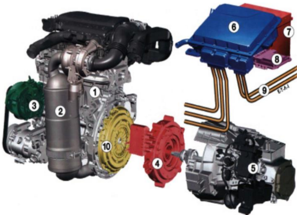
1-ДВГ 2-Стартираща и спираща система 3-Електродвигател 4-Скоростна кутия 5-Инвертор и изправител 6-Управляваща система
