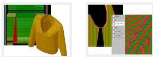
фиг.10 Програма за плоскоплетачни автомати на SDS-ONE APEX3. [3]
