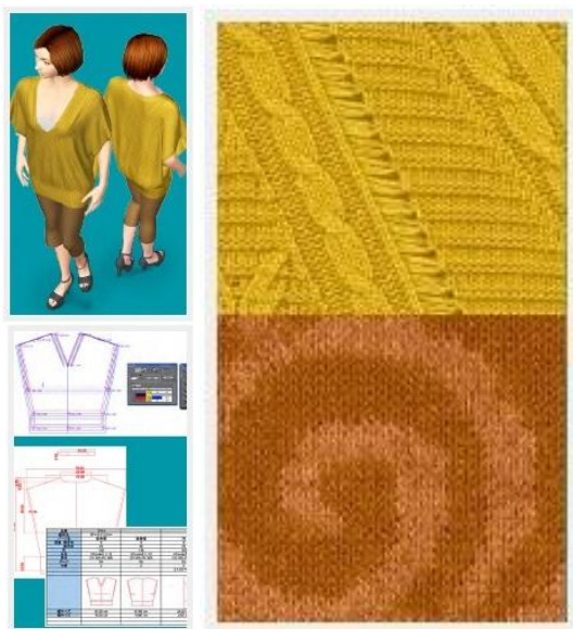
фиг.12 Реалистично тримерно изображение изделието и трикотажната структура. [3]
