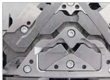
фиг.4 „Секънд стич“ система с контролируема дължина на снемане. [7]
