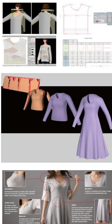
фиг.11 Пътят на безшевното облекло през градирането на детайлите, симулиране на формата му и готовото изделие. [3,4]
