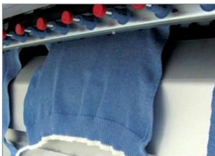
фиг.7 Опъващ механизъм. [7]
