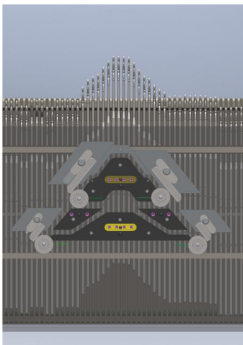
фиг.2 Реалистично тримерно изображение на възелът иглено легло, игли изплитащ механизъм при траектория за плетене на бримка.
