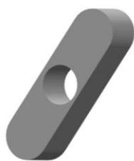
фиг.4 Дясна планка за задвижване на десният снемачия клин за образуване на бримка.
