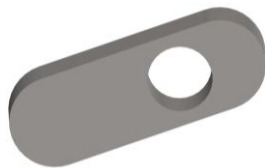
фиг.8 Лева планка за задвижване на десният снемашия клин за образуване на примка.
