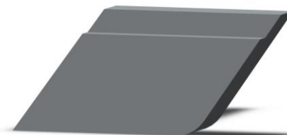
фиг.15 Десен стъпален основен снемач клин за образуване на примка.
