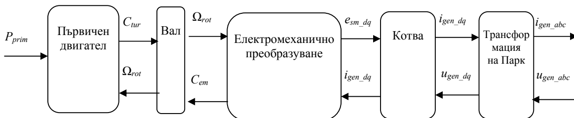
Фиг. 3. Модел на преобразуване на енергията от първичния двигател до котвените токове и напрежения на синхронния генератор
