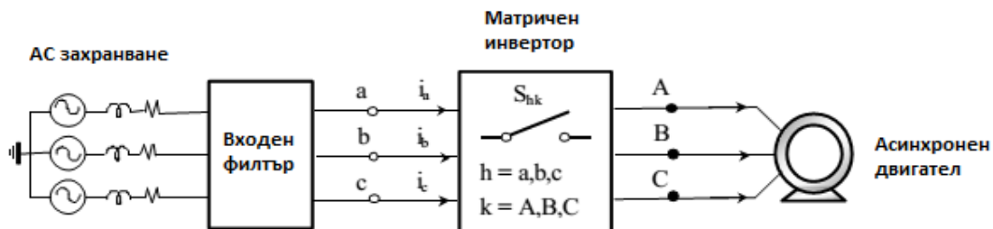
Фиг. 2. Матричен инвертор с входен филтър
