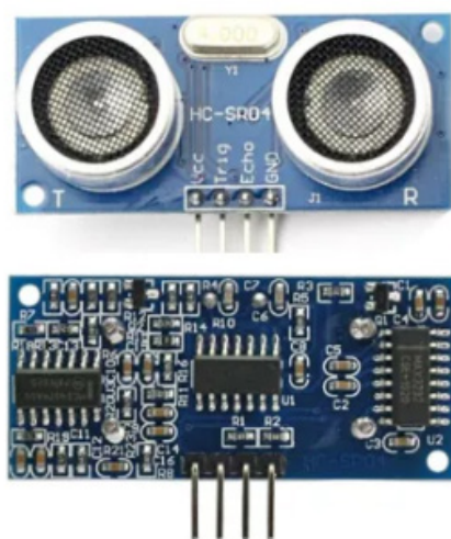
Фиг. 3. SEN136B5B - ултразвуков сензор за разстояние
