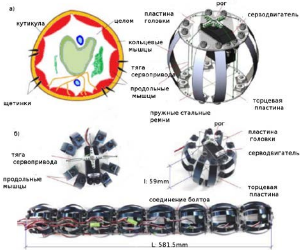
Фиг. 2. Мехатронное устройство червячного типа: а) сравнительный разрез дождевого червяка и одного сегмента МУ; б) конструкция МУ.
