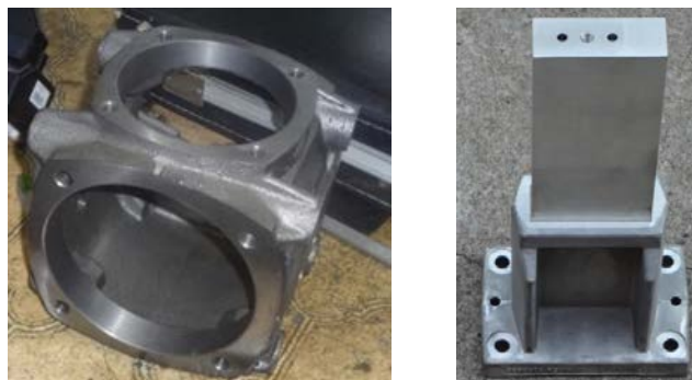
Фиг. 5. Обработени детайли с помощта на фиксиращия модул.
