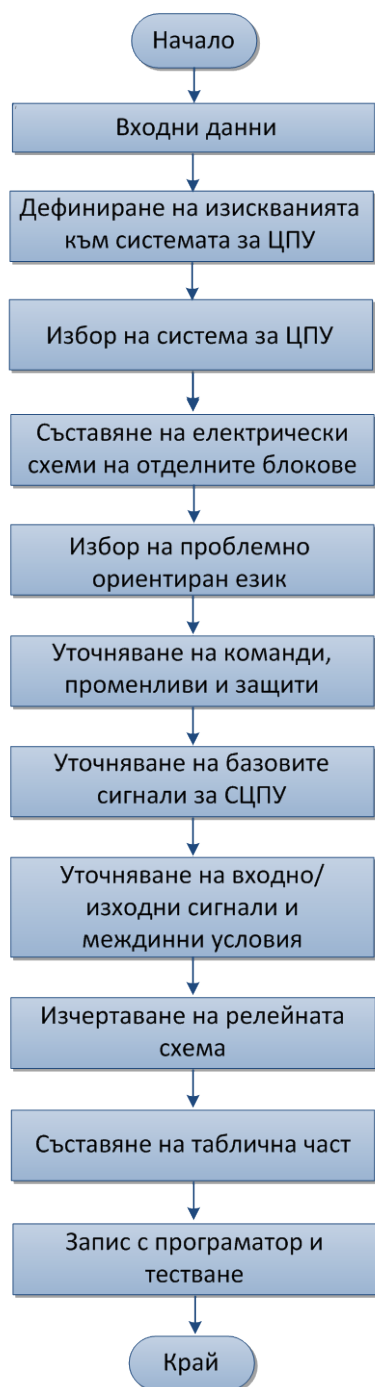
Фиг. 1. Блокова схема на алгоритъма за разработка на ладер диаграма.
