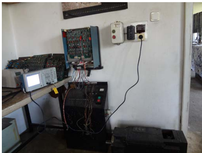
Фиг. 6. Настройка на електрозадвижване за шпиндела.
