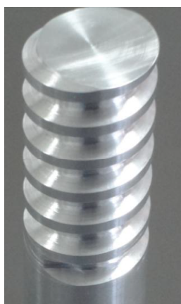
Фиг.9. Изработени детайли с едноходова резба и с двуходова резба.
