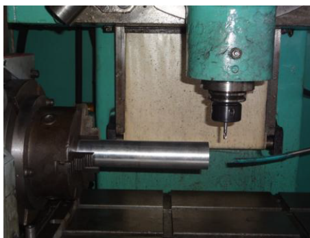
Фиг.6. Процеси на позициониране на инструмента и фрезване.
