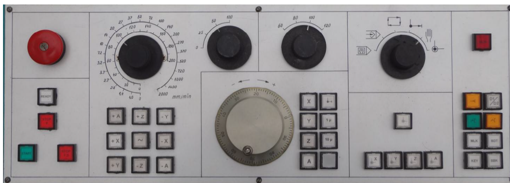
Фиг.7. Изработеният „Пулт за управление“ с монтираните на него елементи.
