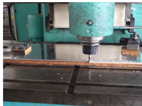
Фиг.6. Процеси на позициониране на инструмента и фрезване.
