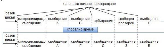
Фиг. 3. Структура на TTCAN протокол
