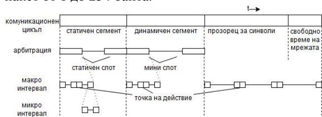
Фиг. 1. Структура на FlexRay протокол
