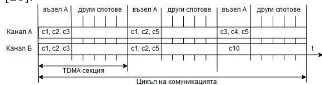
Фиг. 2. Структура на TTP/C протокол
