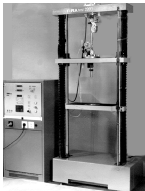
Фигура 4. Общ вид на динамометър TIRA Test 2200 [4]
