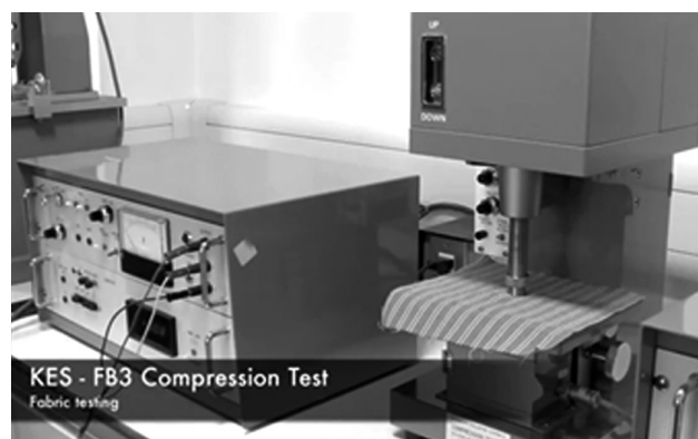
Фигура 1. Модул FB3 на системата KES [1]
