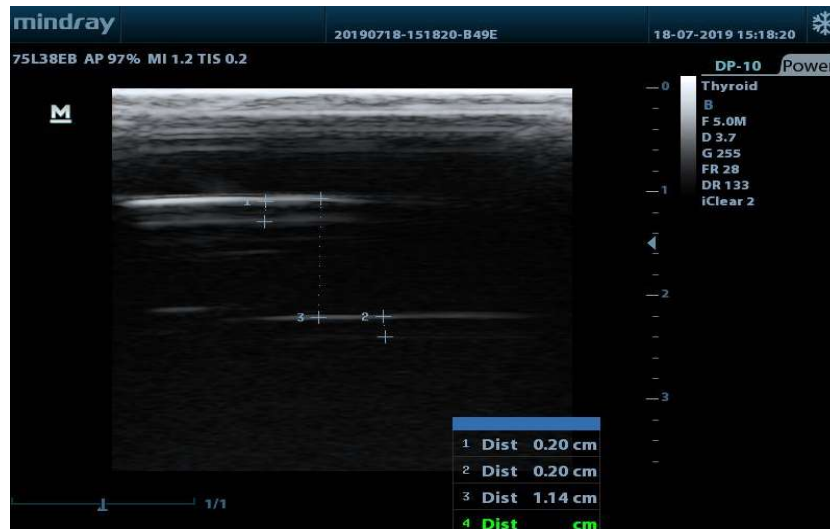
Фиг. 6. Фантом с два отвора и измервания на разстоянието между тях
