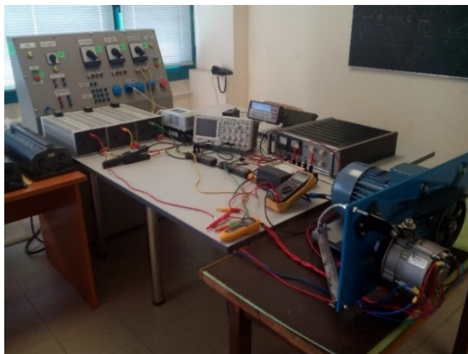
Фиг.3 Лабораторен стенд за експериментално изследване на алтернатори.
