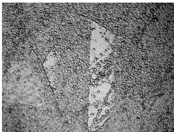
Фиг. 6. Топография на покритие от ZrN върху стомана X25H20 при T=400°C, Us=0 V, (x1000).
