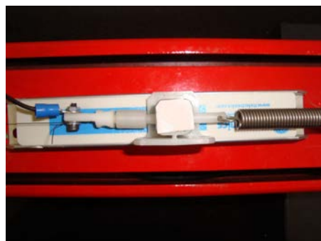
фиг. 3 Магнитен безконтактен сензор за преместване тип АРО-075-001
