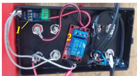
Фиг. 4 Част от електрическият панел на стенда: 1. Сензор за измерване на ток ACS712; 2. Едноканално реле тип ISO9002.
