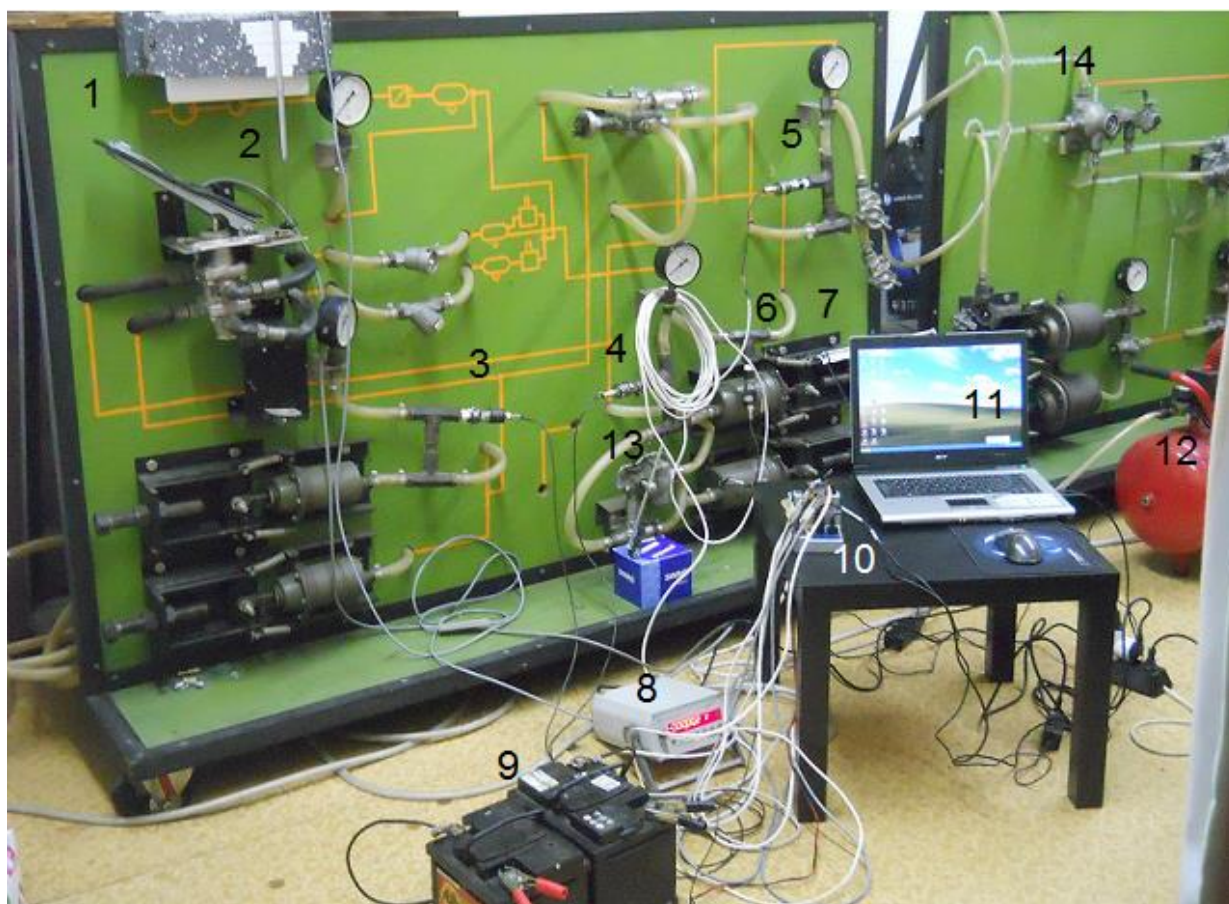
Фиг. 2. Стенд за изследване показателите на спирачно задвижване: 1 – възприемател за сила на спирачния педал; 2 – възприемател за преместване на педала; 3 – възприемател за налягане на преден спирачен цилиндър; 4 – възприемател за налягане на заден спирачен цилиндър; 5 – възприемател за налягане на въздушната магистрала към ремаркетото; 6 – възприемател за налягането в резервоара; 7 – възприемател за преместване на пръта на заден спирачен цилиндър; 8 – тензометричен усилвател; 9 – захранване – 24 V; 10 – DAQ; 11 – PC; 12 – компресор; 13 – регулатор на спирачната сила на задния мост; 14 – спирачно задвижване на ремаркетото.
