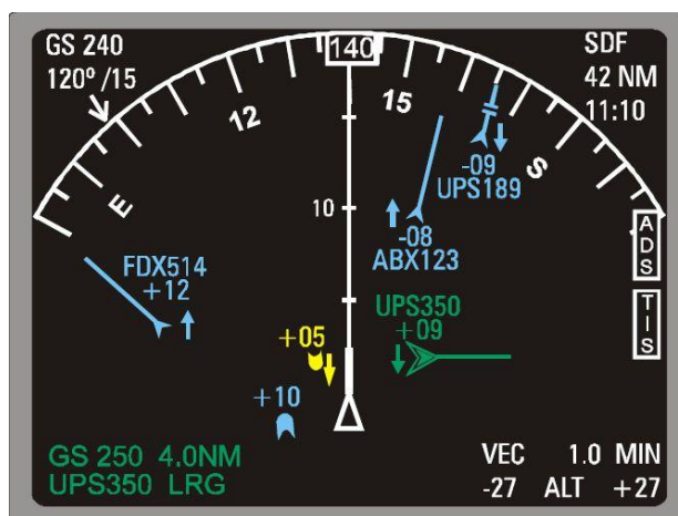
Рис. 3 [9] Пример представления воздушного пространства системой ADS-B TIS
