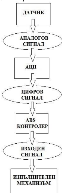
Фиг. 3. Блокова схема на основните процеси на работа на антиблокажна система на автомобил
