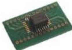
Фиг.4.3. датчик за наклон ADXL202 / ADXL210 на Analog Devices
