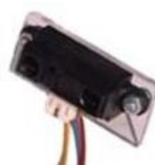
Фиг.4.4. инфрачервен сензор GP2D12 на Sharp.
