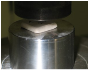
Фиг.1. Порцеланова плочка в зоната на натиск на машината.
