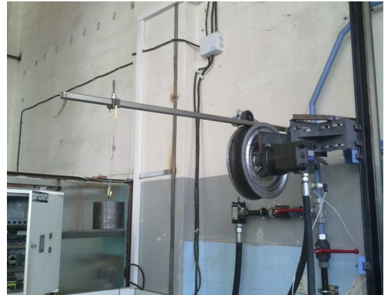
фиг.3 Монтирани хидравличен двигател с ролка за натоварване, тахометър за измерване на ъгловата скорост на ролката, датчици за налягане на входа и на изхода на двигателя
