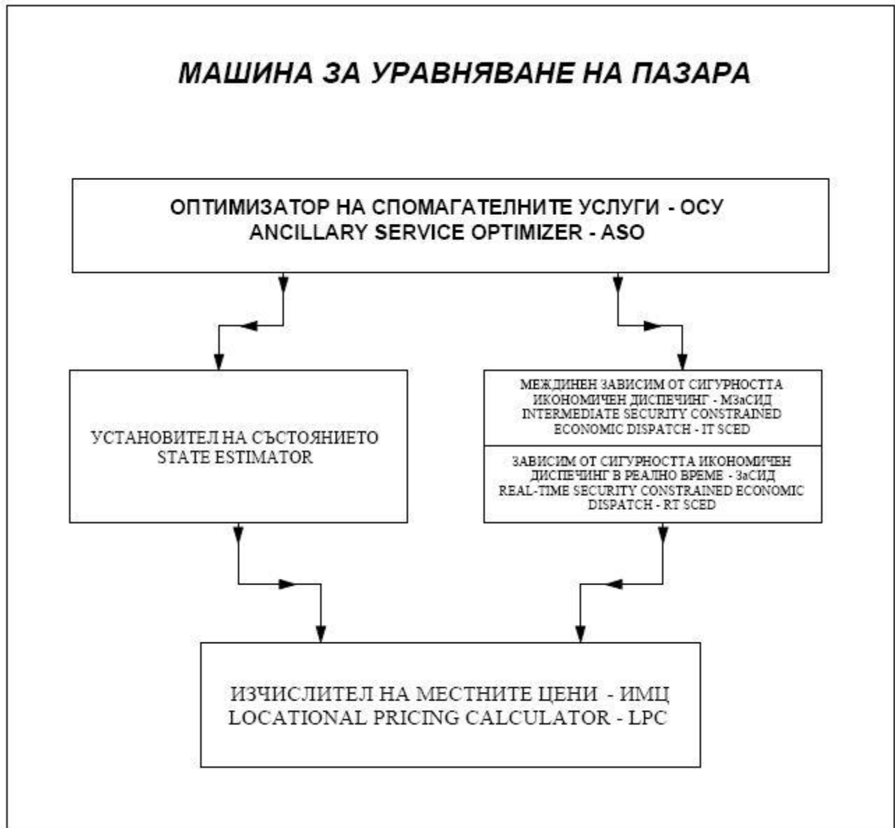
Фиг. 1 Блок схема на взаимодействията между приложенията, съставляващи машината за уравняване на пазара
