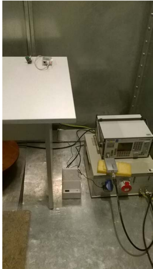
Фиг.2. Изпитвателна постановка в лаборатория „Електромагнитна съвместимост“.
