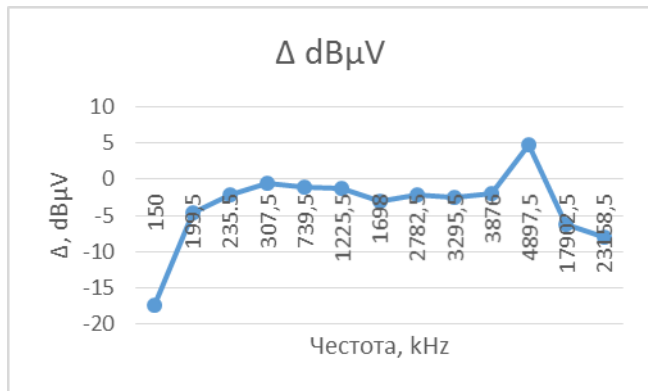
Фиг.10. Графично представяне на разликата между двете измервания на смущения в нулевия проводник (N).
