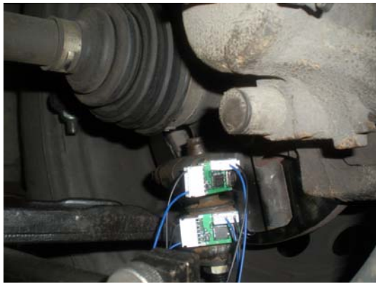
Фиг.2. Разположение на сензорите на елементите на окачването
