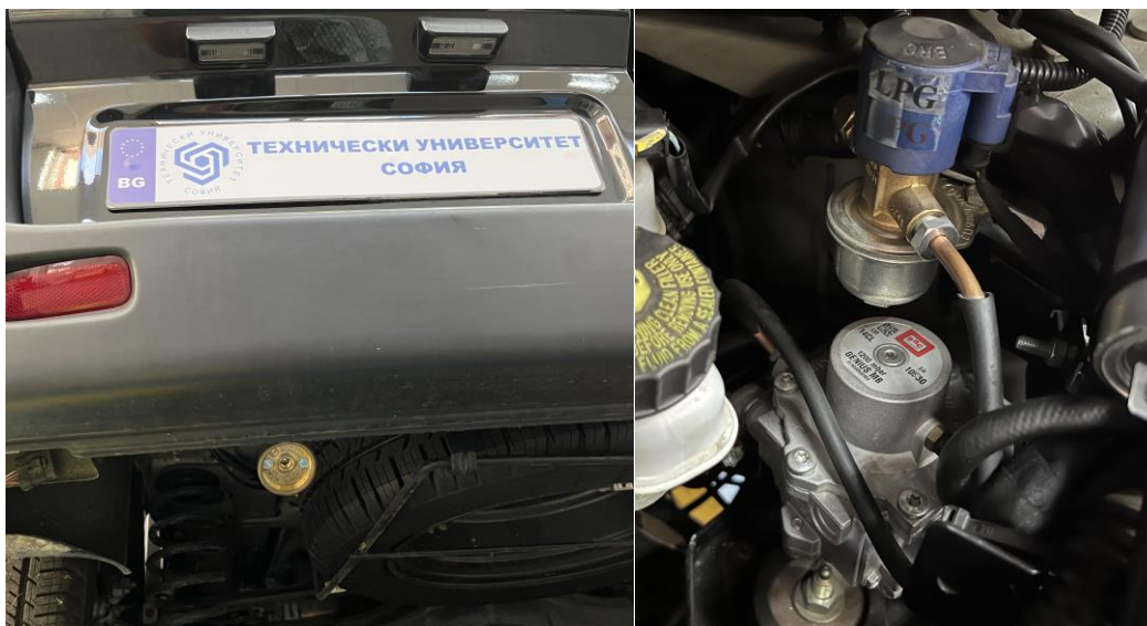
Фигура 3. Пълначо устройство, електромагнитен клапан и редуктор-изпарители за LPG отговарящ на изискванията на правило 67 R.
