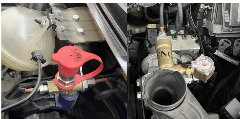
Фигура 2. Електромагнитен клапан, пълначо устройство и редуктор-изпарители за CNG отговарящ на изискванията на правило 110R.
