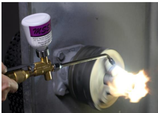
Фиг.6. Наваряване на детайл чрез газотермично прахово наваряване
