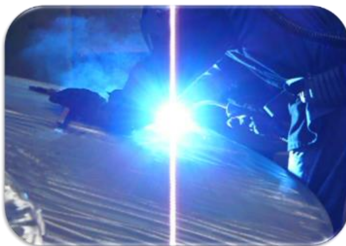
Фиг-4 Заваряване/наваряване на лопатка на гребен винт
