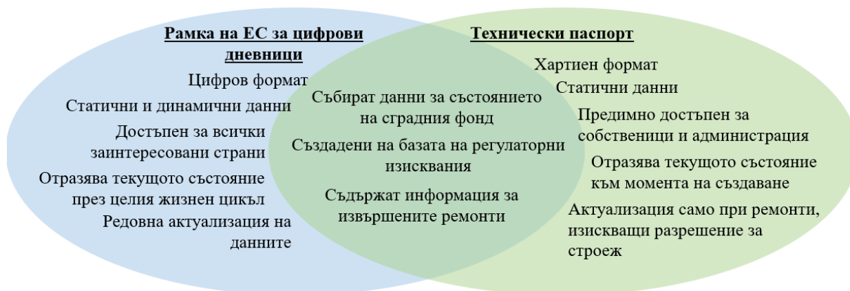
Фиг. 2. Сравнение между рамката на ЕС за цифрови дневници и техническия паспорт
