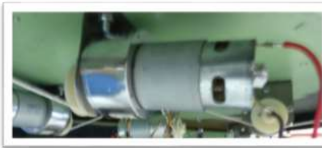
фиг.3 Монтирани от долната страна на основата постоянно токови двигатели
