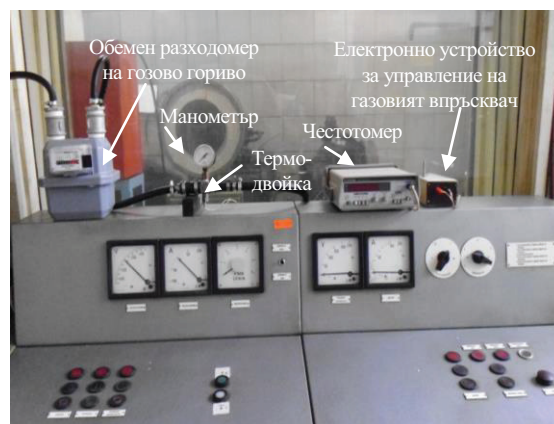
Фиг.4. Пулт за управление на спирачката и измервателна апаратура
