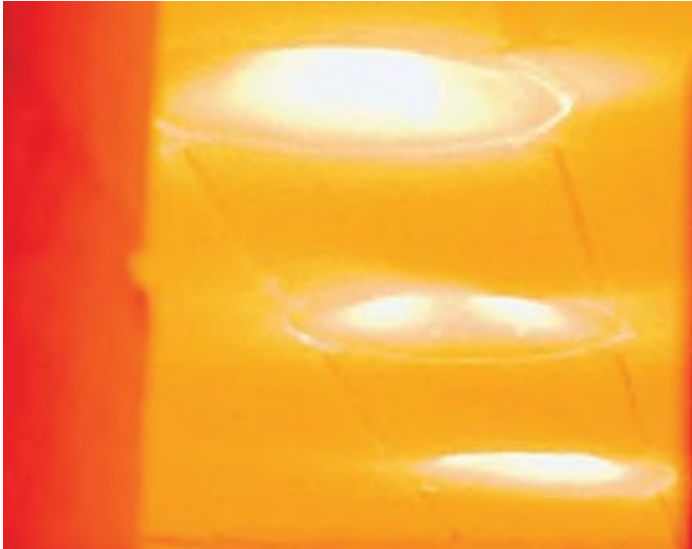
Фиг. 21. Плоскопламъчна триредова горелка „Tenova S.p.A” – реално изображение.
