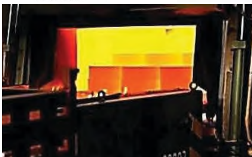
Фиг. 23 Стенни горелки за пещи с подвижен под Selas Duradiant®.
