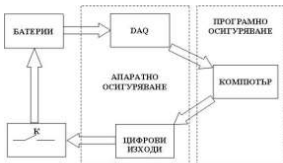
Фиг.1. Структурна блок-схема на система за изпитване на батерии
