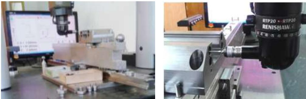
Fig.4 Vermessung der Genauigkeit der Durchmesser der Rücklaufbohrungen eines Rollwagens mit Koordinatenmessmaschine Aberlink [5]
