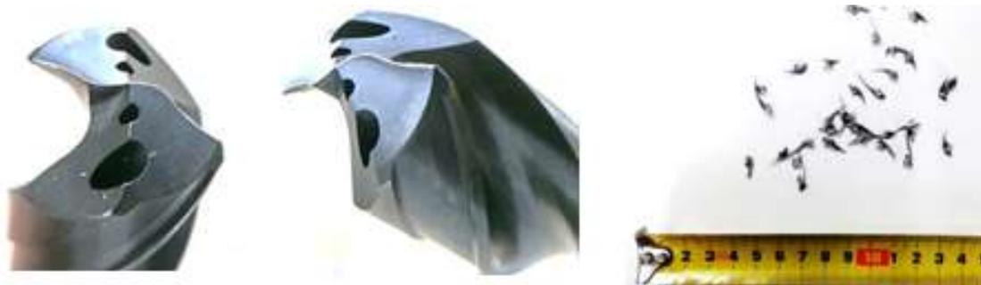
Fig 10 Gleichmäßiger Schneidenverschleiß und minimale Abmaßen der Späne beim Bohren mit dem Werkzeug  $\varnothing 11.03 \text{ H7}$  der Firma Sau und bei  $v_c = 66 \text{ m/min}$  und  $f_z = 0.072 \text{ mm/Zahn}$
