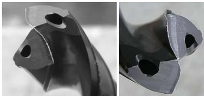
Fig.7 Verschleiß der Hauptschneiden des Hartmetallbohrers  $\varnothing 11.03$  H7 nach 50 m Gesamtlänge der bearbeiteten Bohrungen
