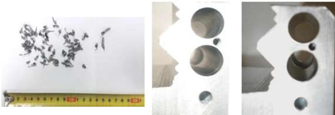
Fig. 6 Form und Abmaßen von abgeschnittenen Spänen beim Bohren von Rücklaufbohrungen mit dem Bohrer  $\varnothing 11.03$  H7 der Firma MK-Tools
