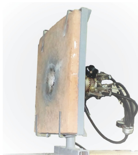
Фиг.1. Плоскопламъчна горелка – експериментална уредба
