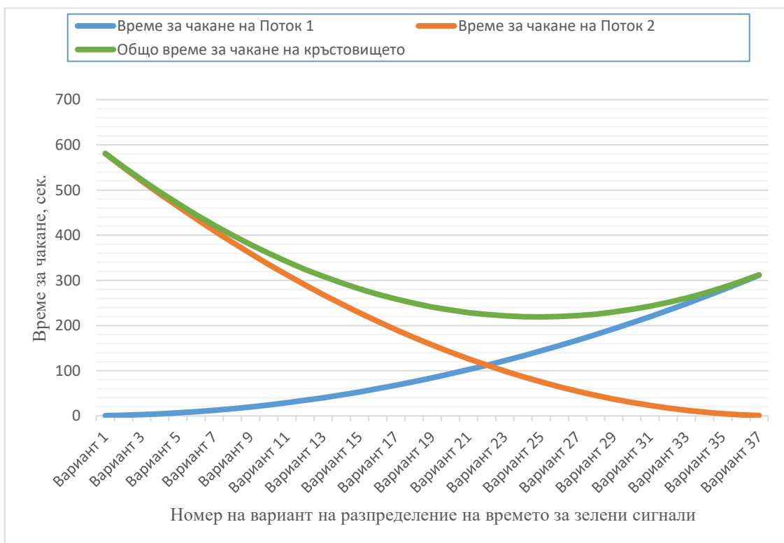
Фиг. 4. Време за чакане на кръстовището при различни варианти на разпределение на времето за зелените сигнали
