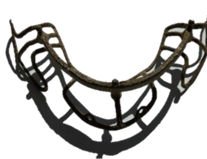
фиг. 2 Субпериостален имплант произведен по технология за адитивно производство
