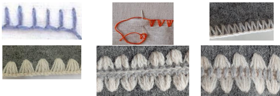
Фигура 5 Фестон бодове, изпълнени на ръка и на машина SIMAC SI-27
