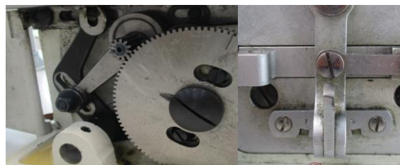
Фиг. 8 Видимата част от задвижващия механизъм (а) и лост за избор на броя на бодовете (б)
