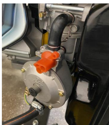
Фиг. 2. Карбуратор за работа на ДВГ с различни горива
