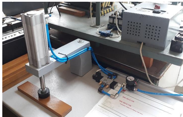
Фиг.2 Допълнителна пневматична скоба на лабораторната установка
