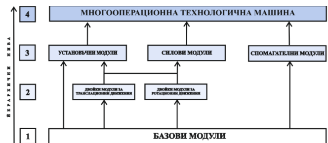
Фиг. 1. Структура на модулна система за изграждане на многооперационни технологични машини
