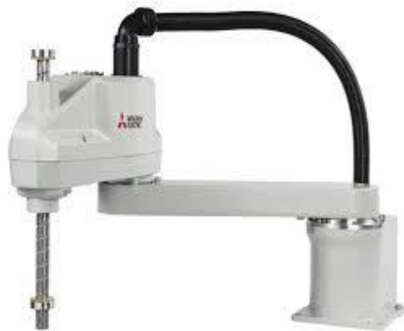
Фиг. 3. Манипулатор RH-6CH7020-D
