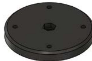
Фиг. 5 Основа за LiDAR скенер
